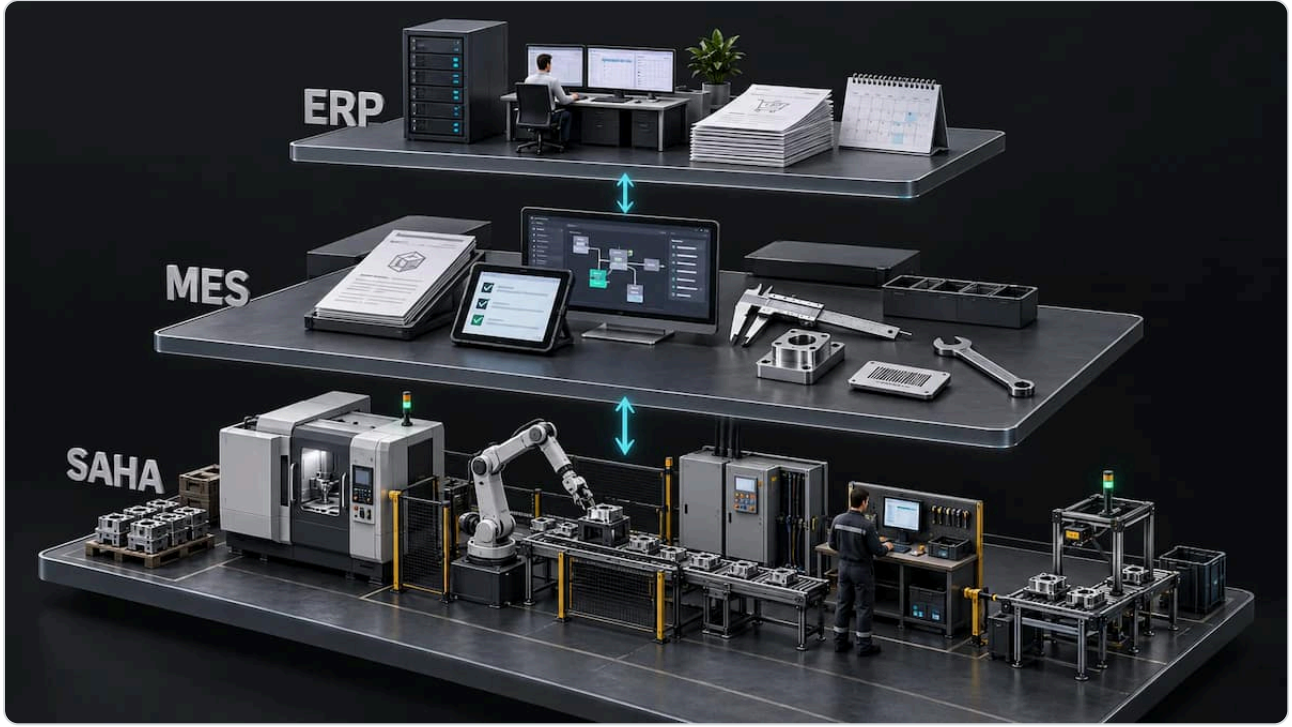
Şekil 1. Sadeleştirilmiş işlevsel ilişki: ERP planı iletir, MES üretimi yürütür ve gerçekleşen bilgiyi geri besler. Görsel bir ağ güvenliği topolojisi değildir.
