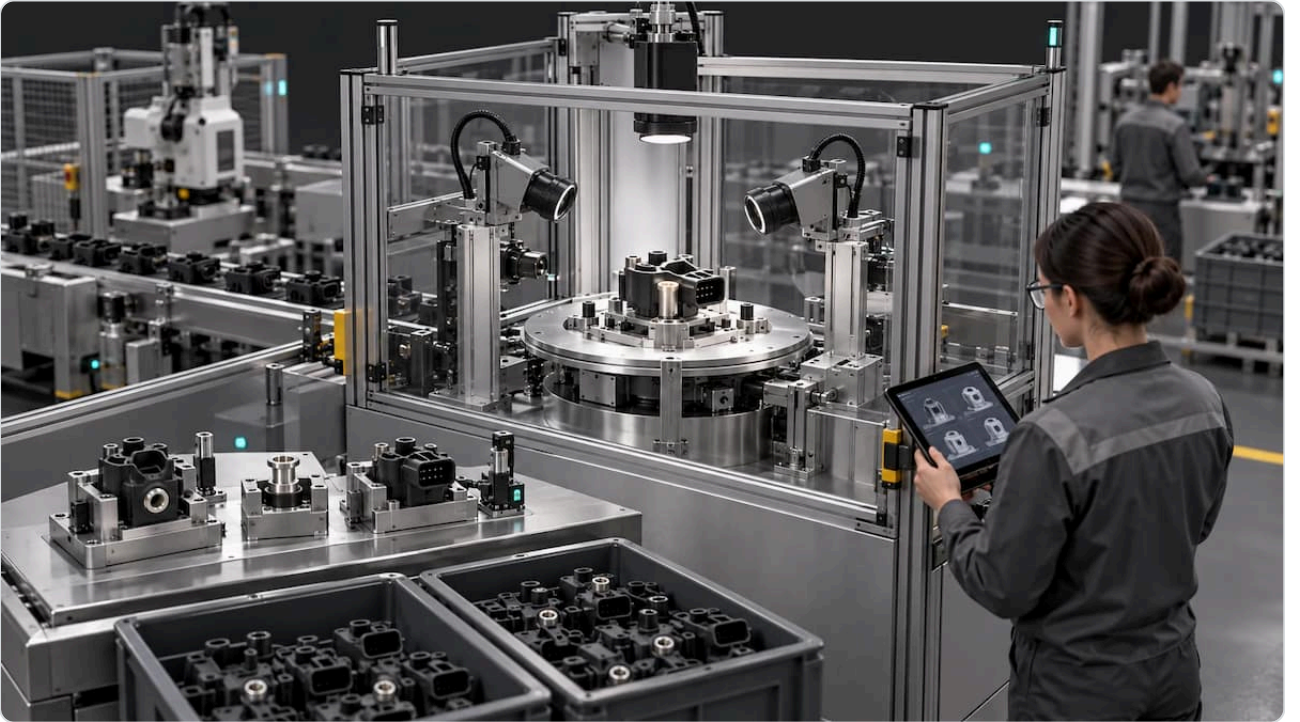
Şekil 3. Çoklu görüntü, görünür yüzey kapsamını artırır. Kameralar fonksiyon, tork veya sızdırmazlık testlerini kendiliğinden üstlenmez.
